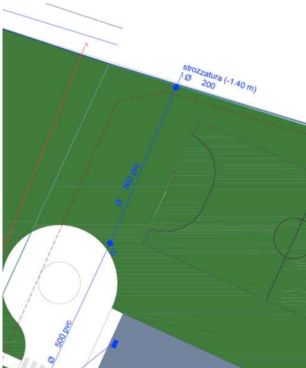
Figura 29 – Dettaglio planimetrico dello scarico nello Scolo Alzata
