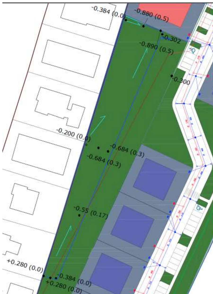
Figura 27 – Planimetria di progetto dell'invaso naturale di laminazione. In nero le quote di progetto, tra parentesi il battente massimo atteso.
