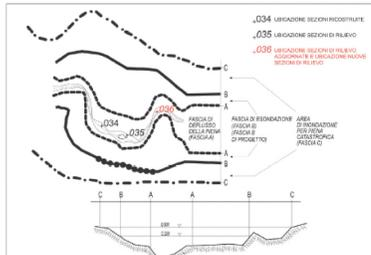
Schema esplicativo per la delimitazione della fascia: pianta e sezione
