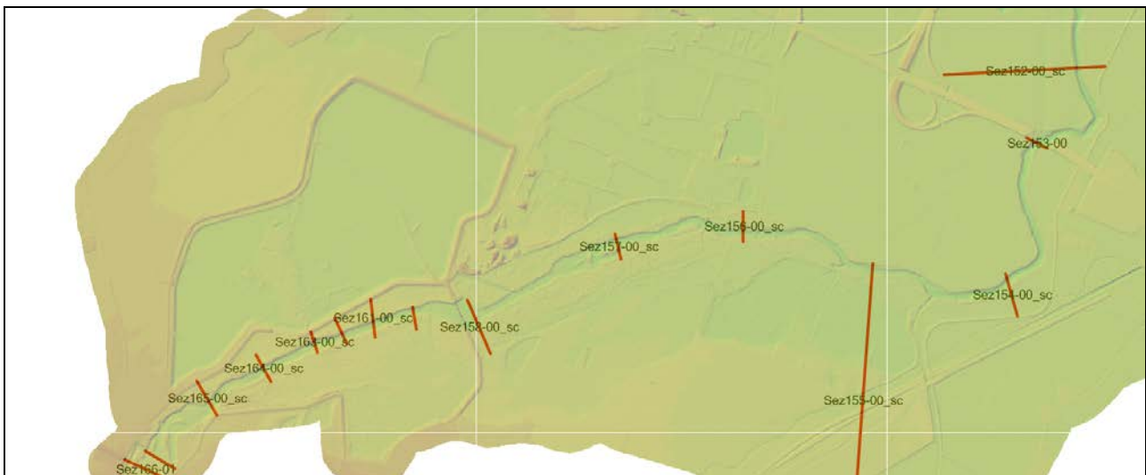
Fig. 3.1.7 – DTM ricavato dal LIDAR 2015
