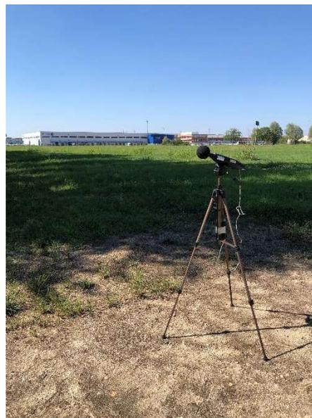
**Postazione P3\_spot** In corrispondenza di questa postazione è stata svolta una misura di breve durata. Questa postazione ha permesso di rilevare gli apporti di rumore strettamente correlati ai flussi di traffico veicolare su via Ponte Alto. La strumentazione è stata posta alla distanza di 10 metro dal ciglio stradale ed ad una altezza di 1,5 metri sul p.c. Durante la misura sono stati rilevati i flussi di traffico sull'asse viario di via Ponte Alto tramite operatore sul posto.
