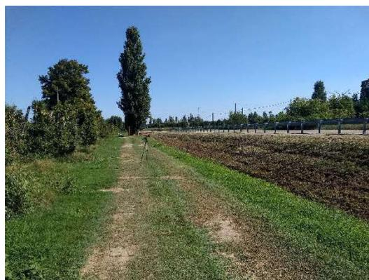
**Postazione P4\_spot** In corrispondenza di questa postazione è stata svolta una misura di breve durata. Questa postazione ha permesso di rilevare gli apporti di rumore strettamente correlati alle operazioni di carico e scarico tramite l'utilizzo di transpallet. La strumentazione è stata posta alla distanza di 2 metri dalle attività di movimentazione e ad una altezza di 1,5 metri sul p.c.
