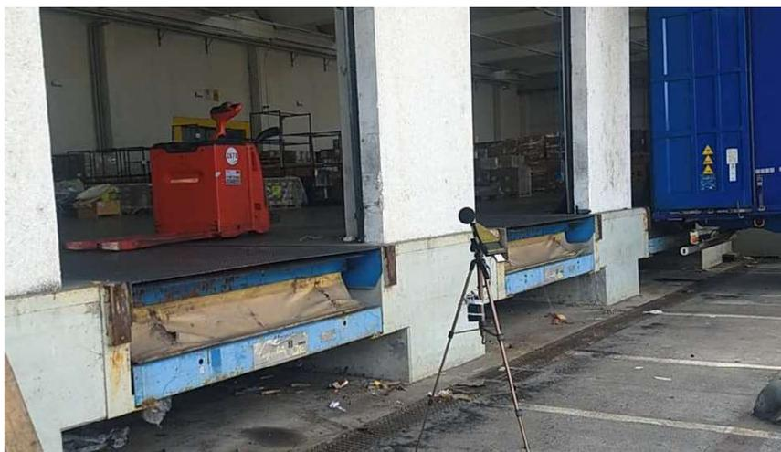
**Postazione P5\_spot** In corrispondenza di questa postazione è stata svolta una misura di breve durata. Questa postazione ha permesso di rilevare gli apporti di rumore strettamente correlati alle operazioni di carico e scarico tramite l'utilizzo di un muletto. La strumentazione è stata posta alla distanza di 2 metri dalle attività di movimentazione e ad una altezza di 1,5 metri sul p.c.
