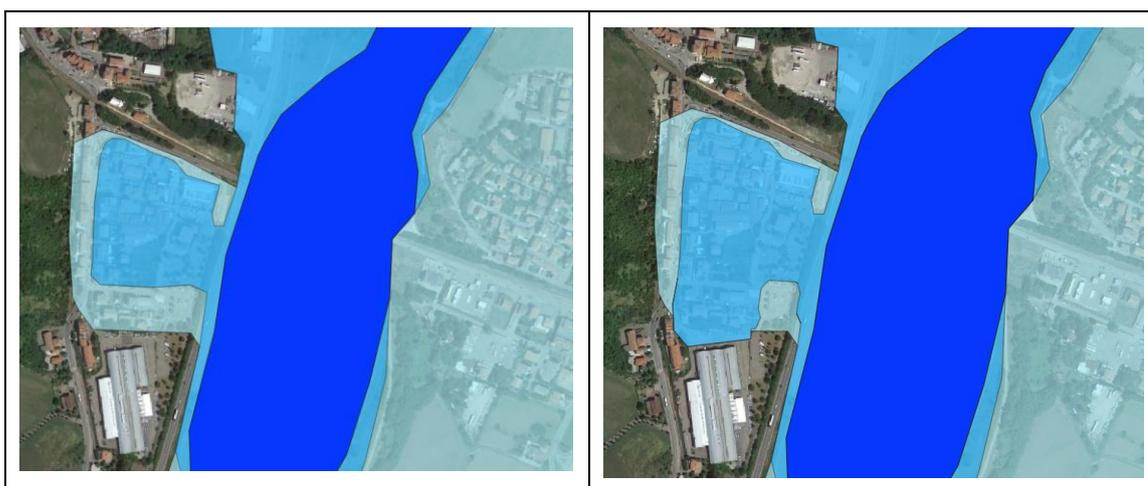
**Fig. 7 – PGRA: a sinistra le aree di pericolosità del PGRA vigente e a destra la proposta di aggiornamento del PGRA per le alluvioni poco frequenti (M) in sinistra del fiume Secchia a monte di Ponte Veggia - Sassuolo**
