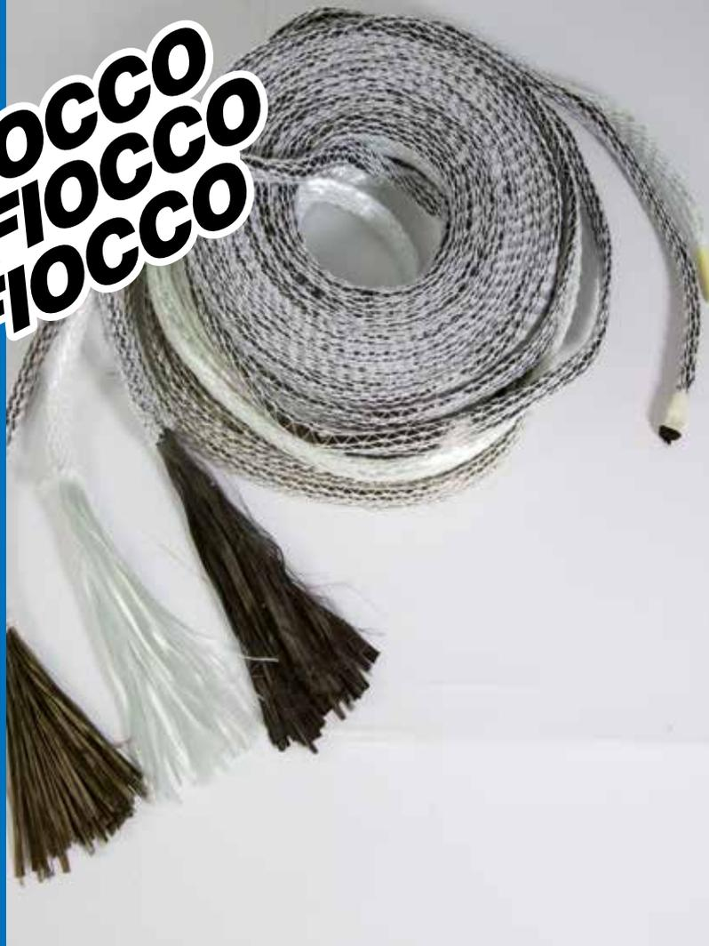
**Corda in fibre di carbonio o vetro o basalto unidirezionali ad alta resistenza da impregnare con MapeWrap 21 per la realizzazione di “connessioni strutturali”**
