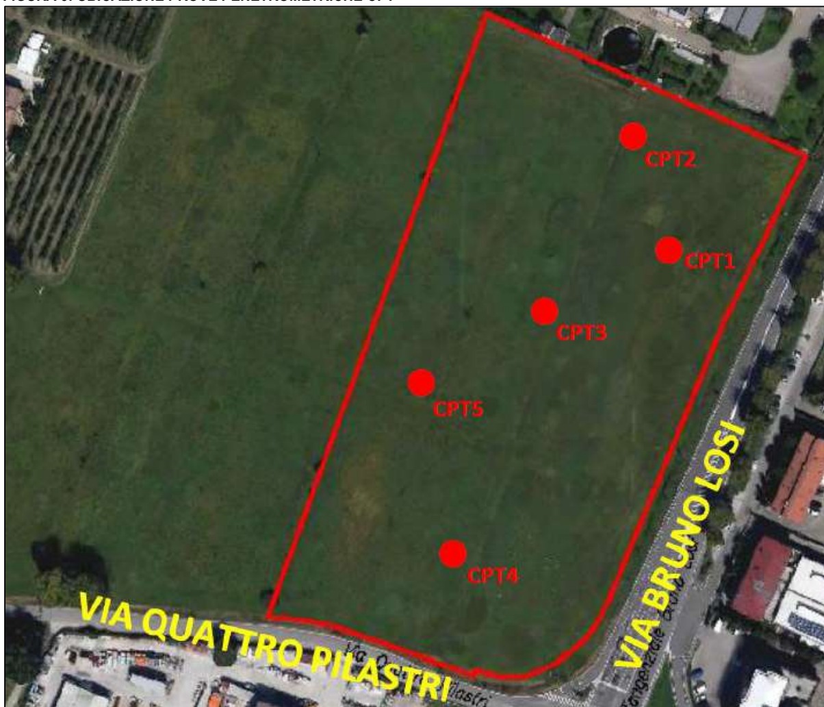
FIGURA 3: UBICAZIONE PROVE PENETROMETRICHE CPT
