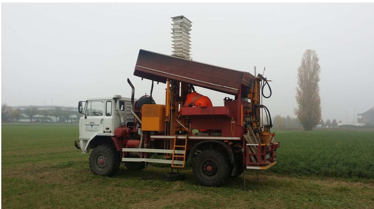
Foto 2 - realizzazione della prova penetrometrica con punta elettrica CPTU
