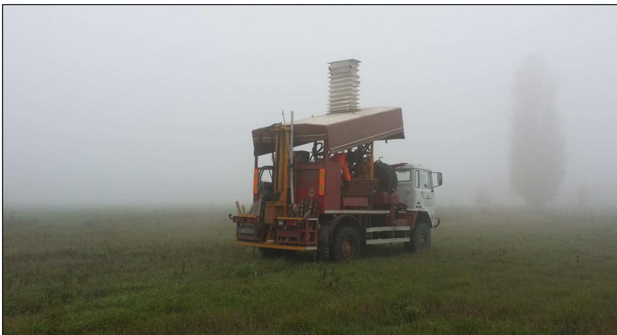
Foto 1 - realizzazione della prova penetrometrica con punta meccanica CPT1
