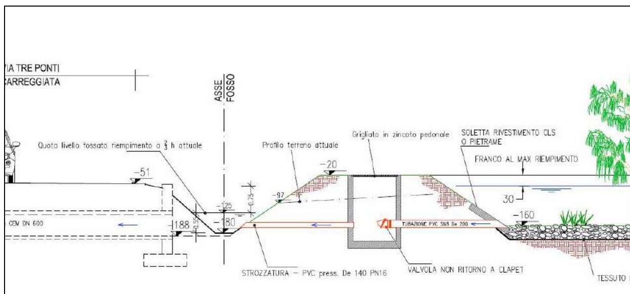
Figura 21 : Particolare sezione idraulica bocca tarata – scarico
