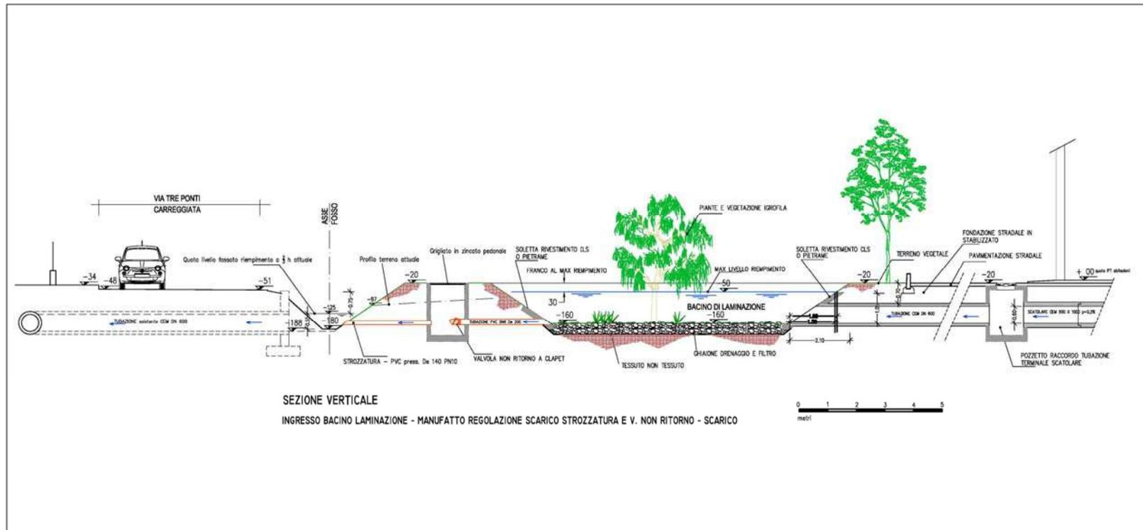
Figura 18: sezione idraulica vasca laminazione – bocca tarata – immissione in acque superficiali
