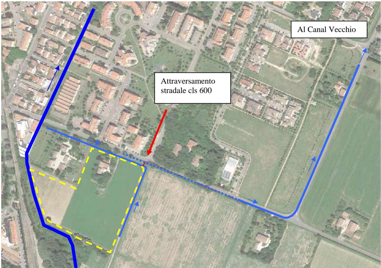
FIG 6A: - ORTOFOTO - RETICOLO IDROGRAFICO DI DETTAGLIO
