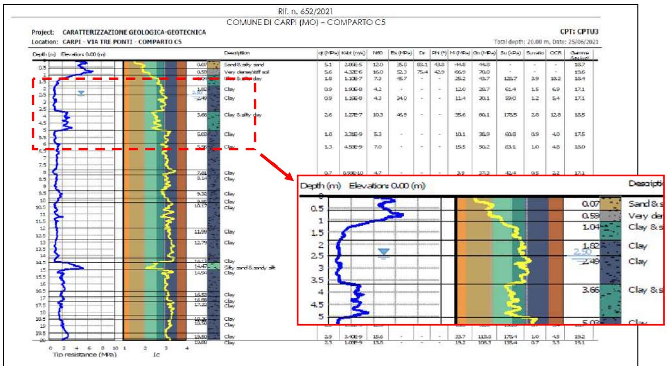
FIG.3- PROVA PENETROMETRICA CPTU 31 CON EVIDENZIATO LIVELLO DI FALDA
