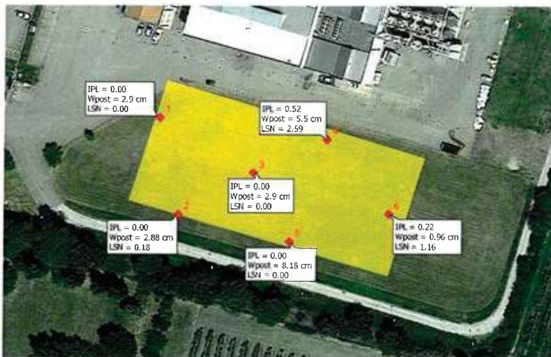
Figura 14- sintesi accertamenti effetti sismici sul terreno
