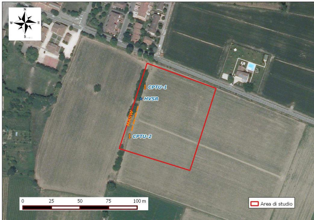
Figura 7 – Ubicazione dei sondaggi penetrometrici e delle indagini geofisiche – MASW e HVSR.
