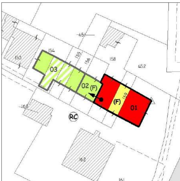
Esito della valutazione danni e perimetrazione UMI
