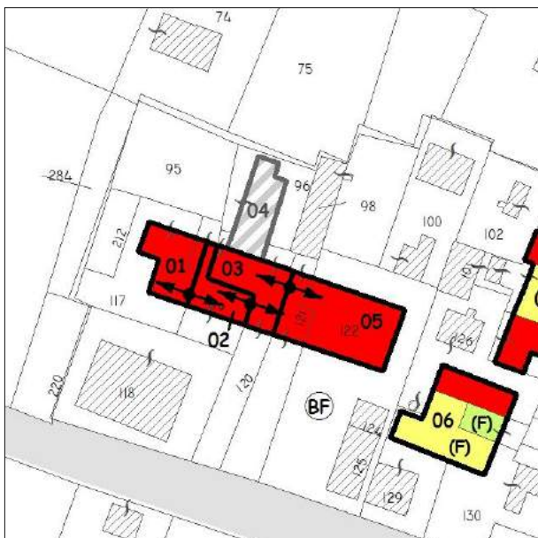
Esito della valutazione danni e perimetrazione UMI
