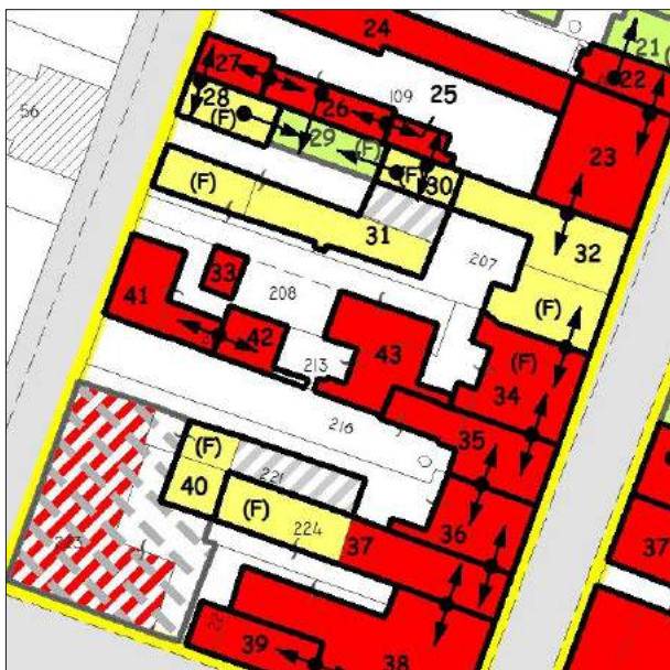
Esito della valutazione danni e perimetrazione UMI
