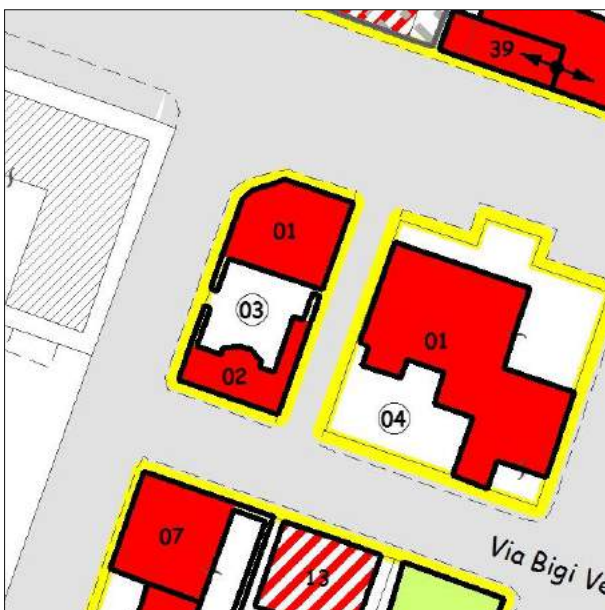
Esito della valutazione danni e perimetrazione UMI
