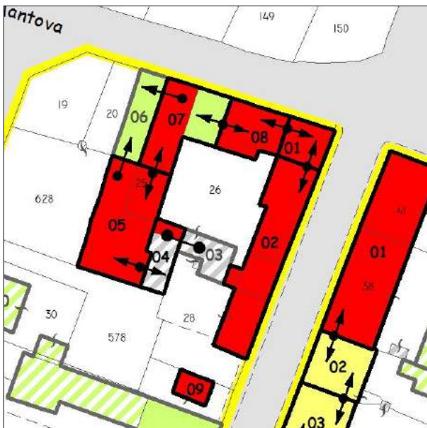
Esito della valutazione danni e perimetrazione UMI
