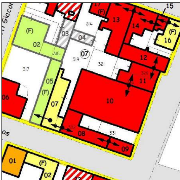
Esito della valutazione danni e perimetrazione UMI
